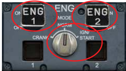
Cde de démarrage des moteurs
